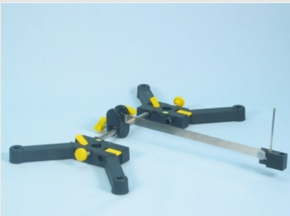
Experimento: oscilación de un resorte de hoja
